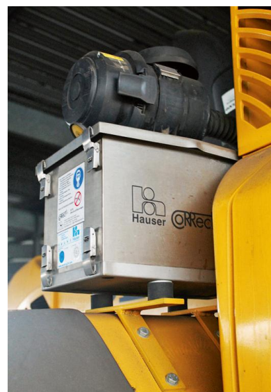
Eine Maschine des Typs A 68 des Unternehmens Backhus (li.) arbeitet mit einer Schutzbelüftung von Hauser in der halboffenen Halle einer Kompostieranlage.
